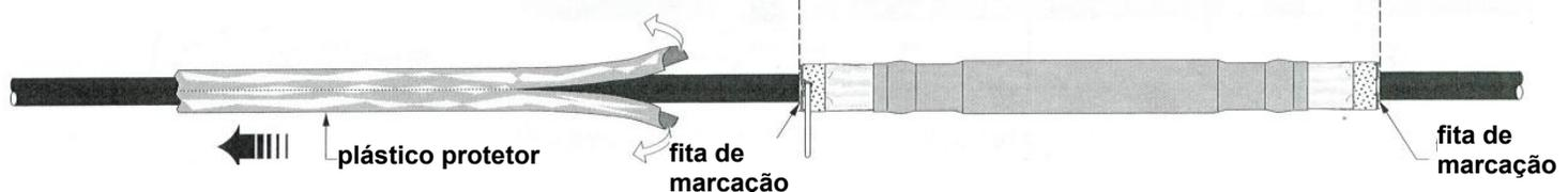
26 – Fixe o conjunto no cabo apertando com firmeza a abraçadeira do cabo na fita de marcação. Remova a fita transparente do lado não fixado.
